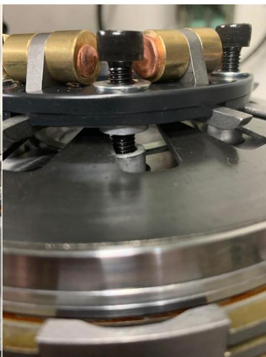
ダイアフラムがずれていない事確かめながらボルトを均等に締め込んでゆく。最終トルクは **10.2~12.4Nm** で4本すべてのボルトを締める。
