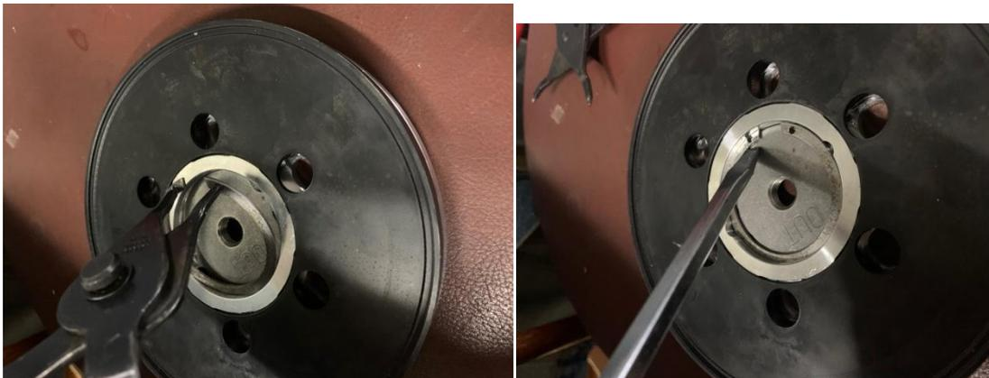
スナップリングがしっかり溝に入っていない場合クラッチが完全に切れなくなりますので注意してください。またアジャスタープレートは5mmほど奥に設置されるようになっていますので予めロックナットを緩めアジャスタースクリューを緩めておきます。
