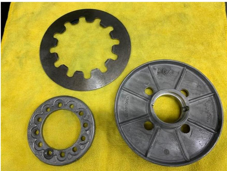
4: ノーマルプレッシャープレートからスナップリングプライヤーを使用してアジャスターボルトプレートを取り外し、VPPに取り付ける。スナップリングの弾力が落ちて
